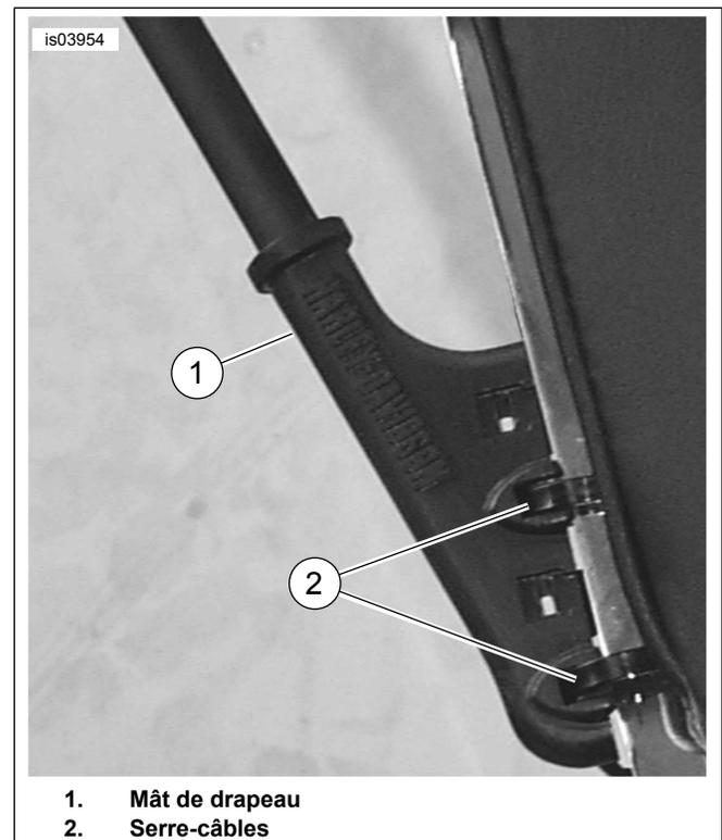
Figure 1. Vue extérieure du mât de drapeau installé
