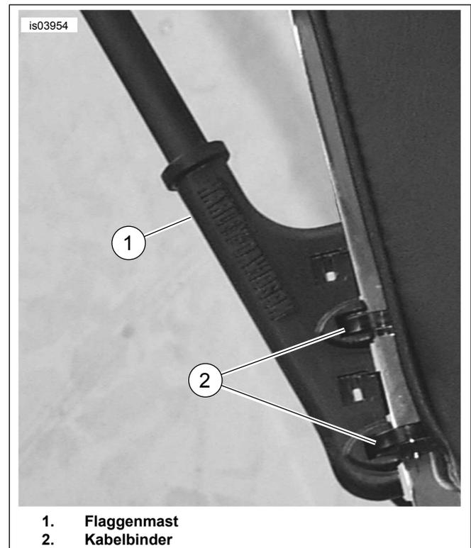
Abbildung 1. Außenansicht des installierten Flaggenmastes
