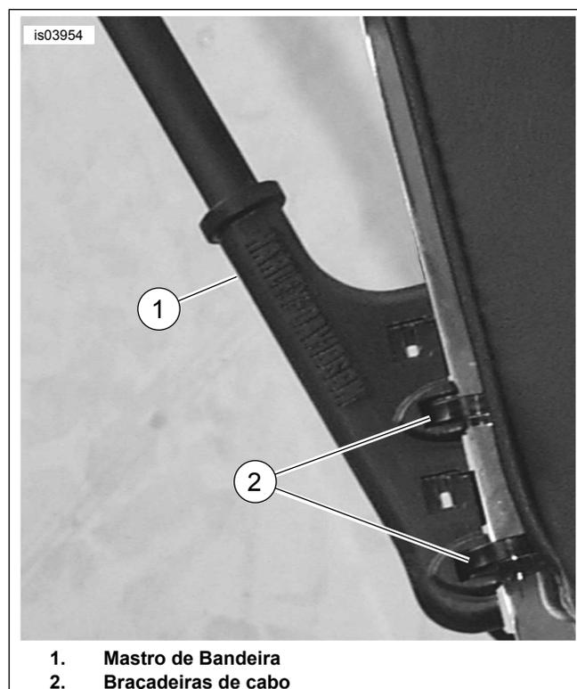
Figura 1. Vista Exterior do Mastro de Bandeira Instalado
