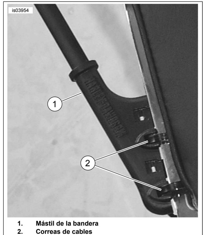
Figura 1. Vista exterior del mástil de la bandera instalado
