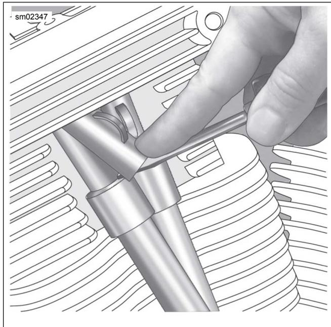
Figure 5. Installer les pièces de retenue de capuchon à ressort
