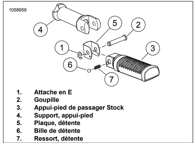
Figure 3. Ensemble d'appui-pied
