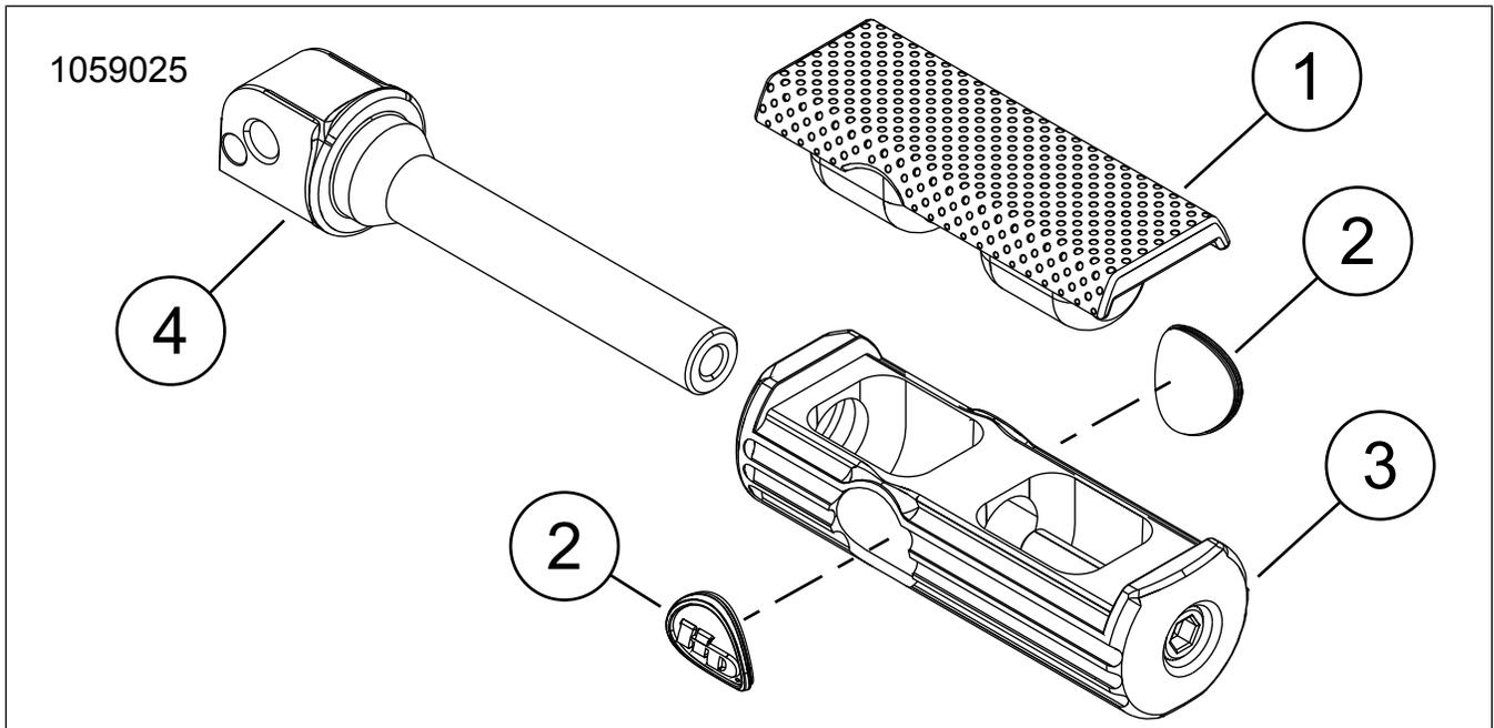
Figure 1. Contenu du kit : Appui-pied de passager
