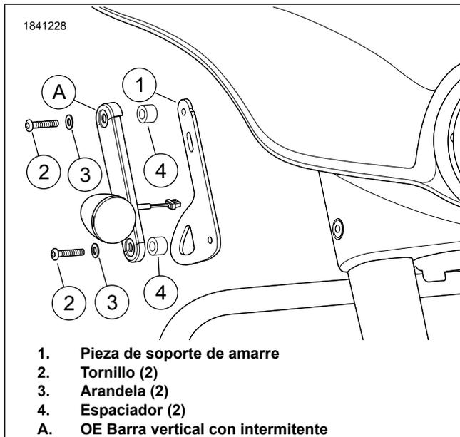
Figura 2. Quitar/colocar pieza de soporte de amarre (se muestra el lado derecho)
