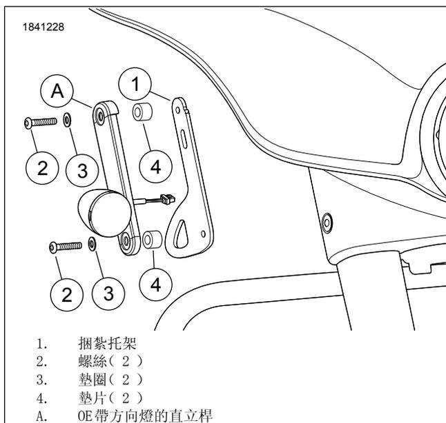
圖2。捆紮托架拆卸/安裝(右側所示)
