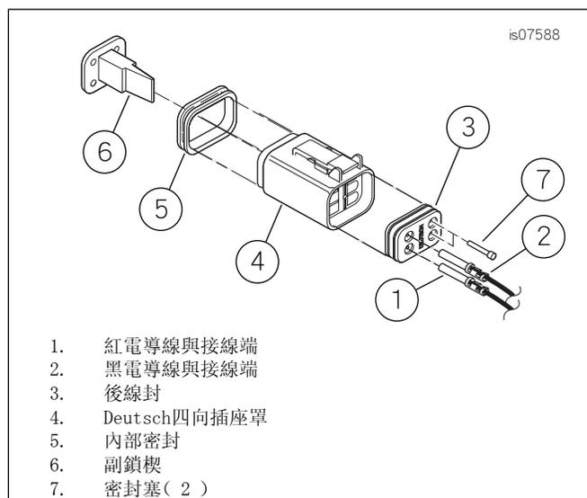
圖4。將接線端插入Deutsch插座罩
