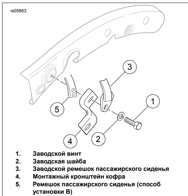
Рисунок 4. Модели 2013 и более ранних годов выпуска: Снимите ремешок пассажирского сиденья и установите комплект 53051-09
