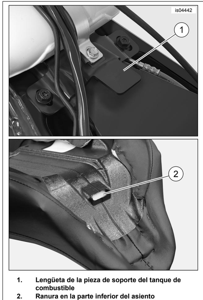
**Figura 7. Montaje del asiento delantero**
