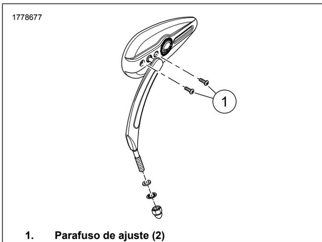
Figura 4. Parafusos de ajuste de tensão do eixo
