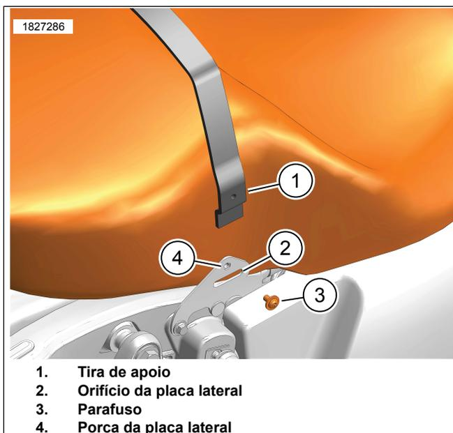
**Figura 4. Instale a correia de apoio do assento**
