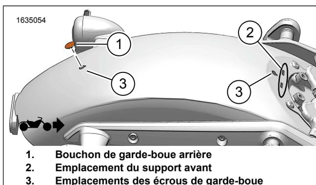
Figure 2. Retirer le bouchon du garde-boue arrière
