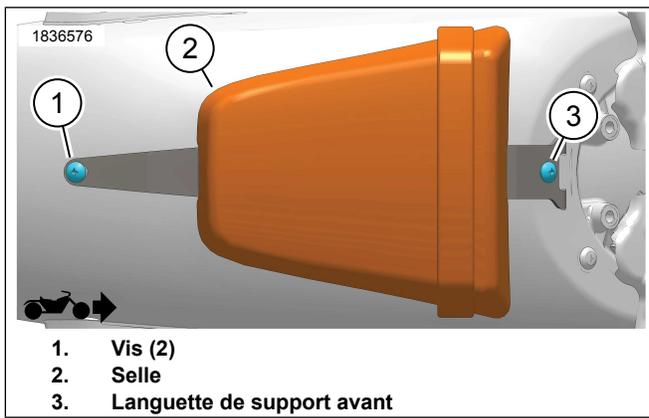
**Figure 4. Installer le siège passager**
