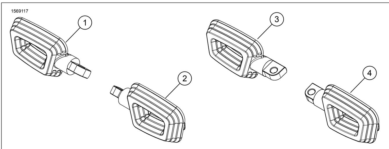
Figure 4. Pièces de rechange : Repose-pied- Conducteur/passager (collection Empire illustrée)
