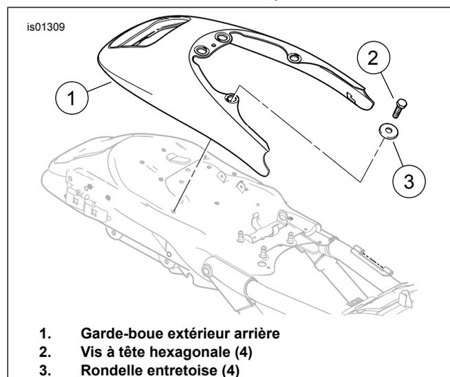
**Figure 10. Fixations de montage de garde-boue (modèles VRSCR de 2006 à 2007)**
