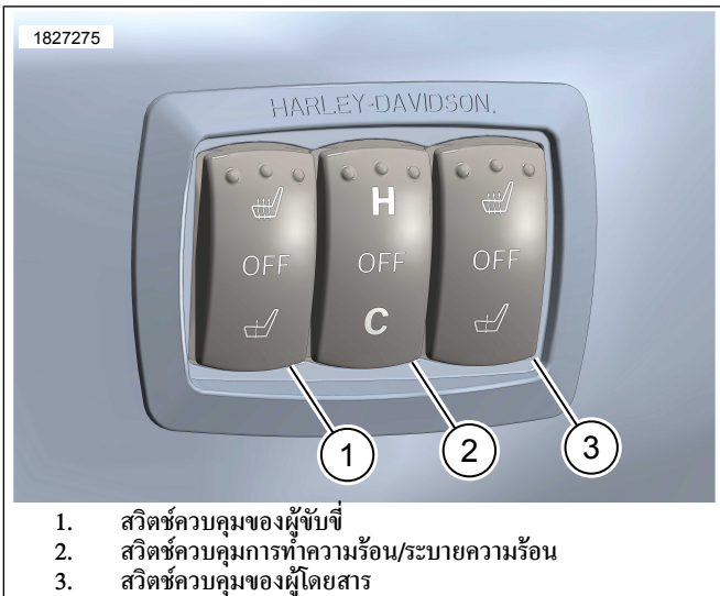
รูปภาพ 3 สวิตช์ควบคุมการทำความร้อน/ระบายความร้อนที่นั่ง
