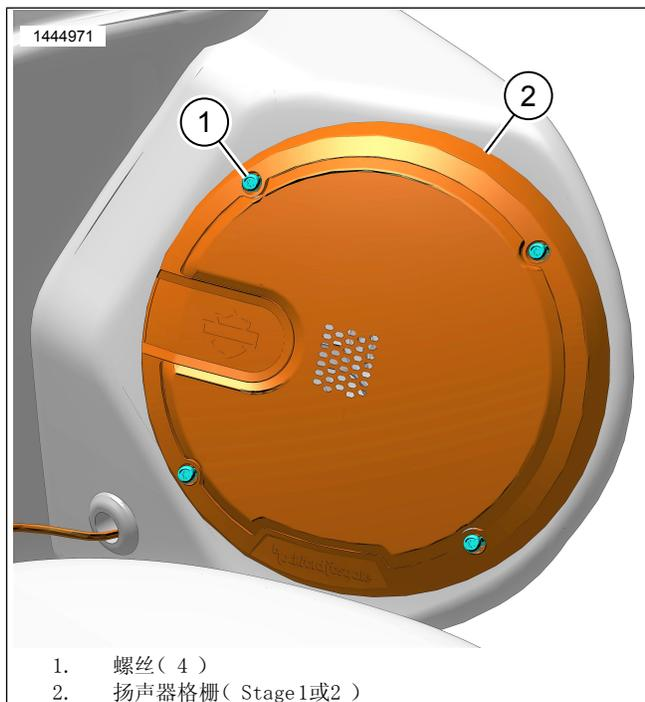
图3。音箱格栅（图示为左侧）
