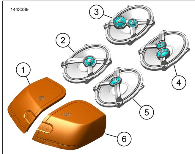
Figure 3. Pièces de rechange, kit de haut-parleurs de sa-coches Boom! Audio de l'étape 2
