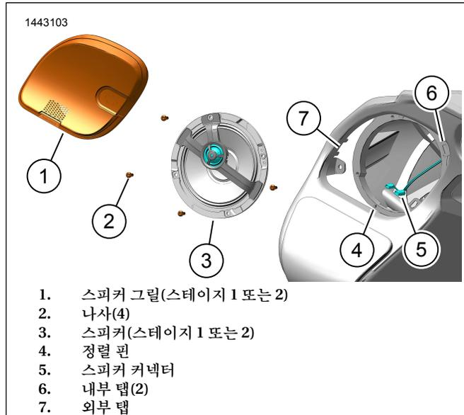
그림 2. 스피커 인클로저 설치(왼쪽 표시)
