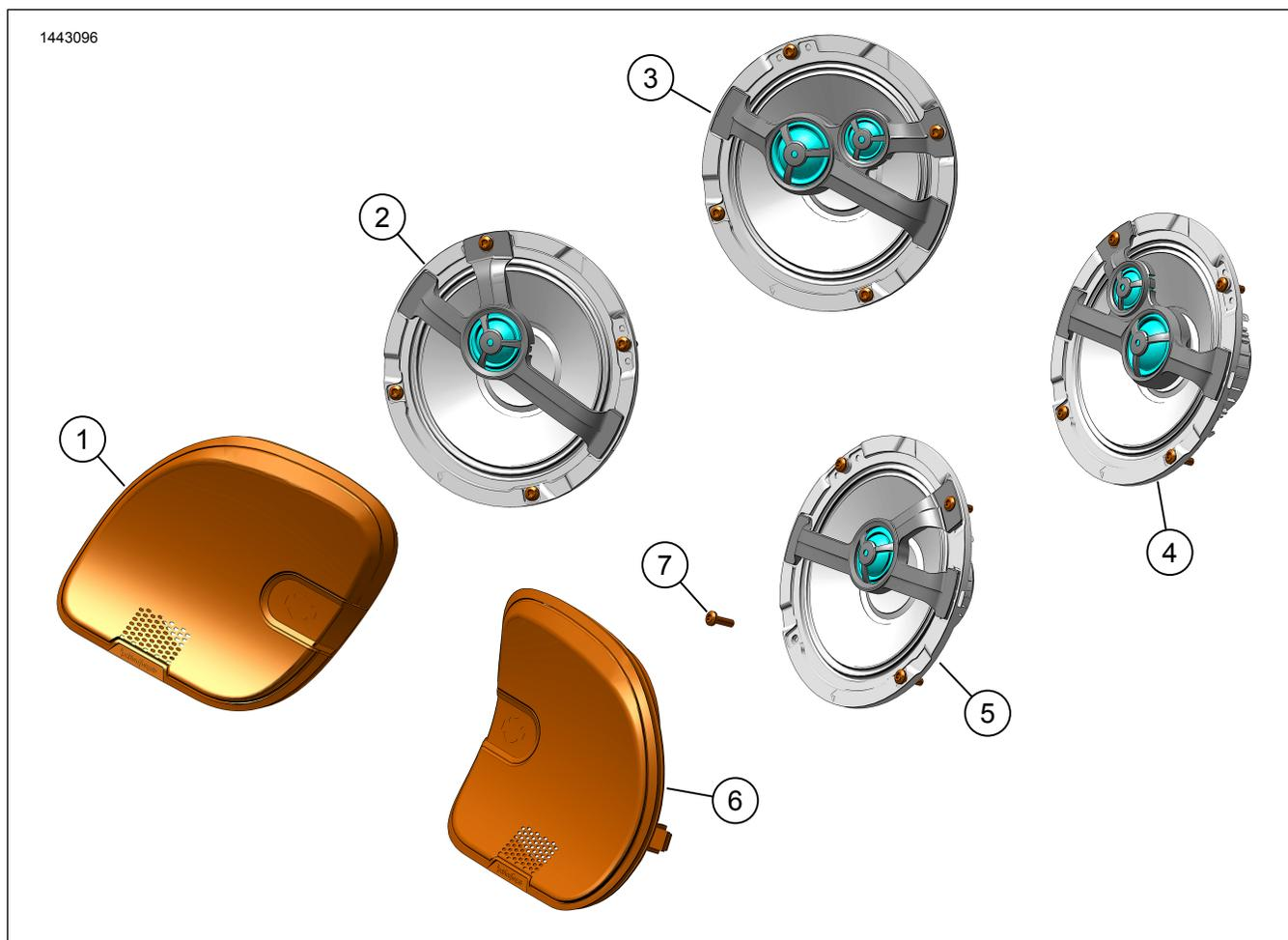
Figure 4. Pièces de rechange, kit de haut-parleurs de carénage avant Boom! Audio de 165 mm (6,5 po)
