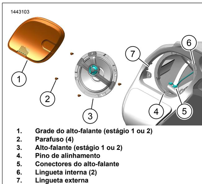
Figura 2. Instalação da caixa do alto-falante (lado esquerdo exibido)
