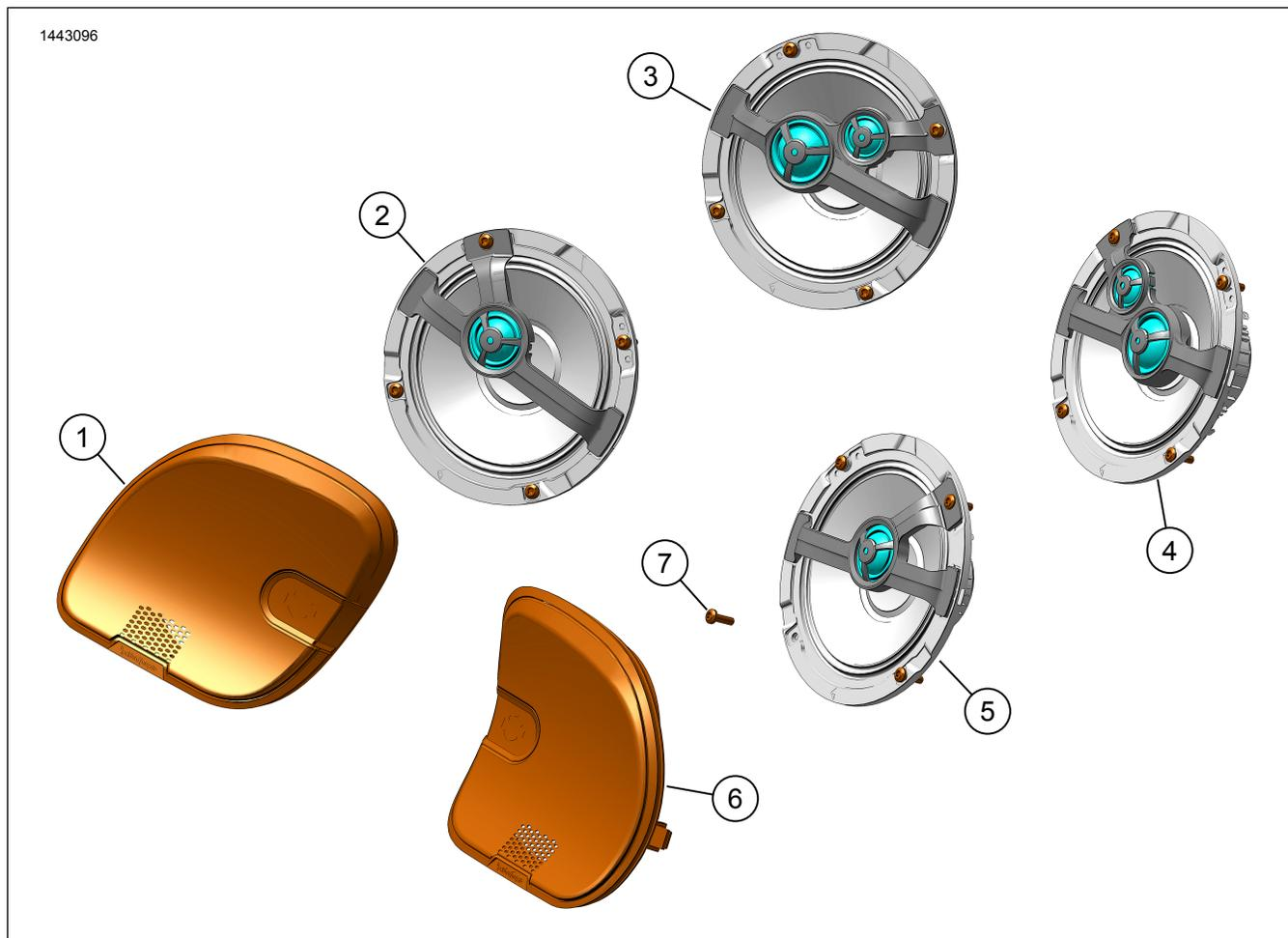
Figura 4. Peças de reposição, kit de alto-falantes da carenagem dianteira Boom! Audio 6,5 pol.
