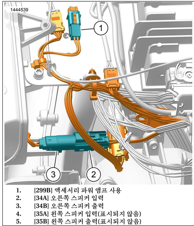
그림 2. 프레임 장착 스피커 하네스(오른쪽 표시, 왼쪽도 유사함)
