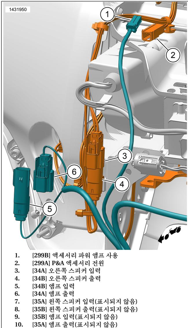
그림 1. 포크 장착 스피커 하네스(오른쪽 표시, 왼쪽도 유사함)
