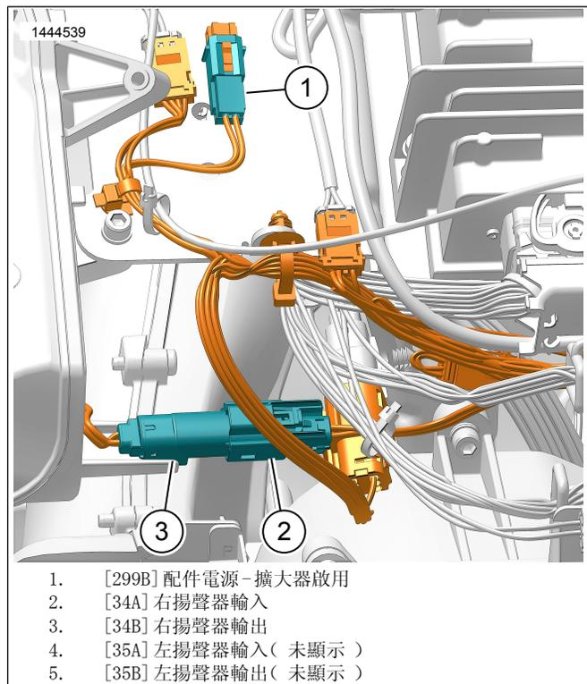
圖2。車架安裝揚聲器線束(顯示右側,左側相似)
