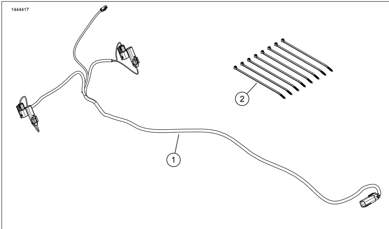
圖4。維修零件，擴大器安裝工具包
