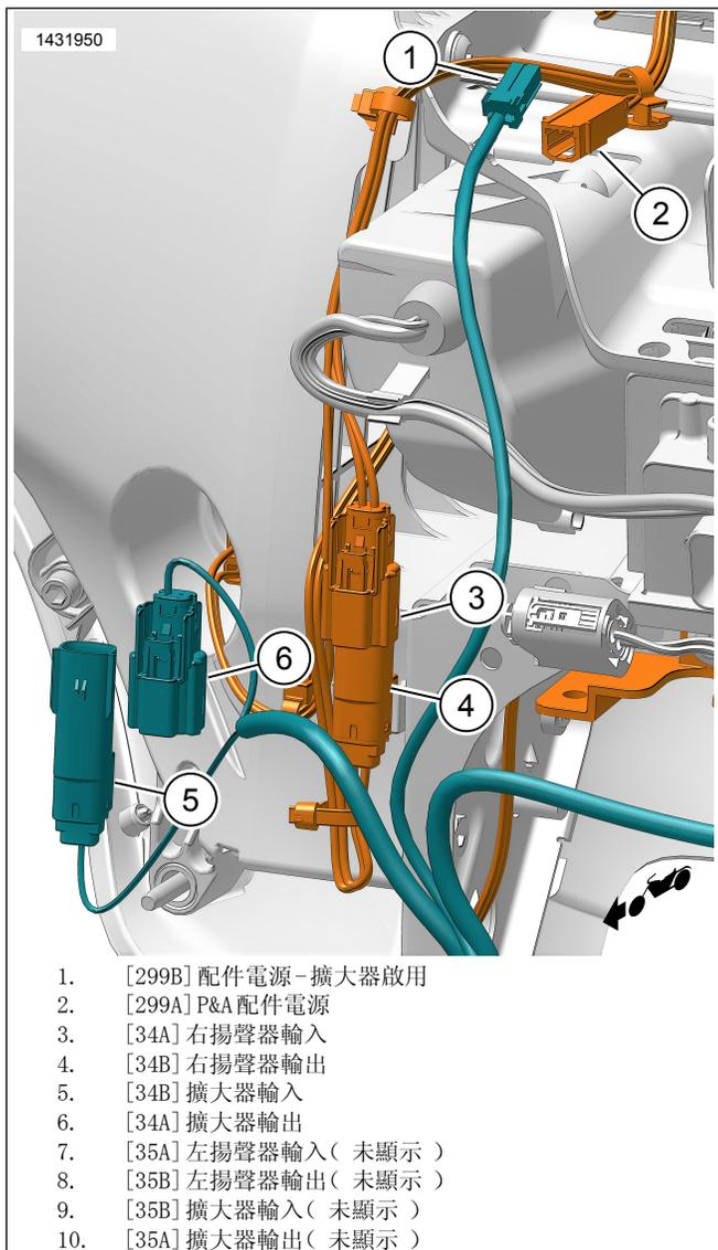
圖1。車叉安裝揚聲器線束(顯示右側,左側相似)
