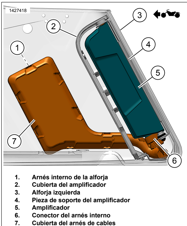
Figura 8. Arnés de la alforja con amplificador
