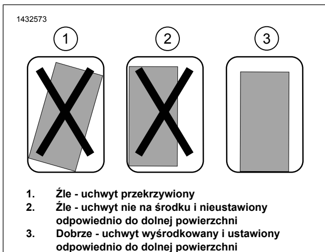
Rysunek 4. Instalacja uchwyty montażowego
