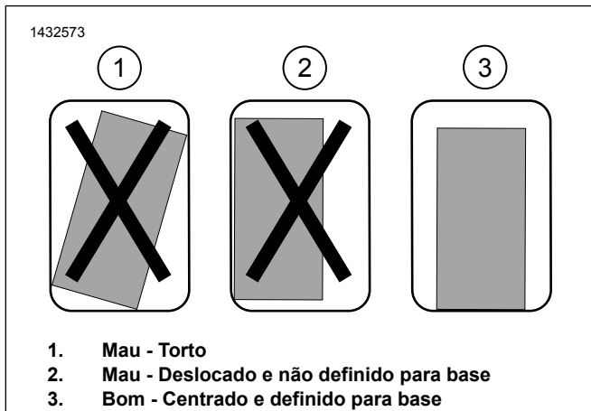
Figura 4. Instalação de suporte de montagem
