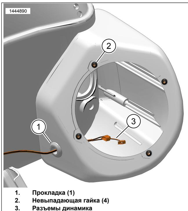
Рисунок 1. Жгут проводов корпусного динамика (показана левая сторона)
