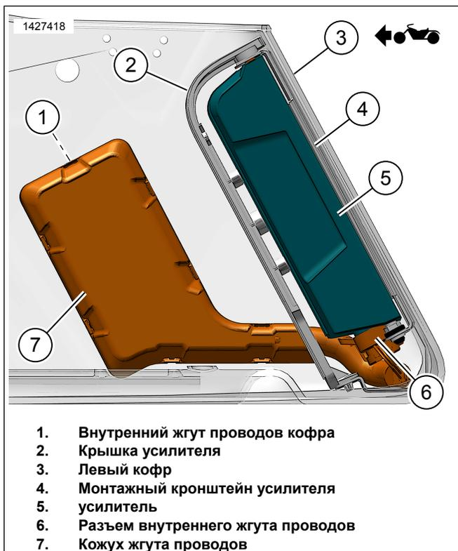
Рисунок 8. Жгут проводов кофра с усилителем
