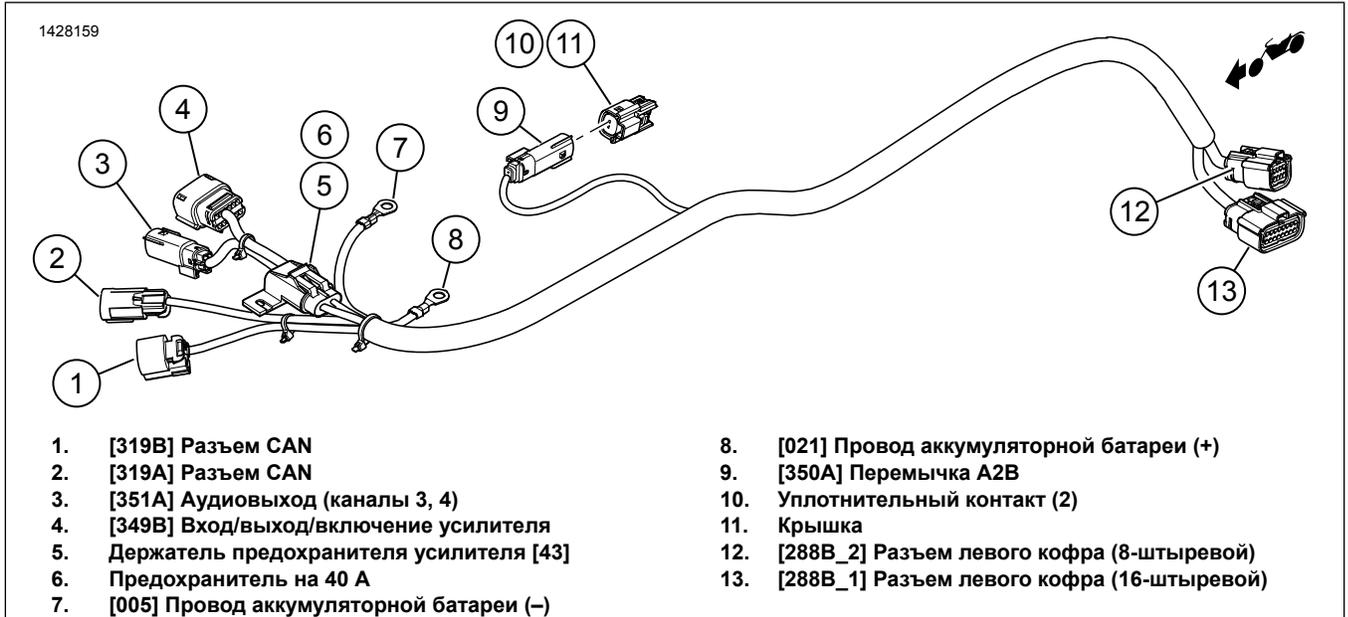
Рисунок 13. Разъемы внешнего жгута проводов (модели 2017 и более поздних модельных годов)
