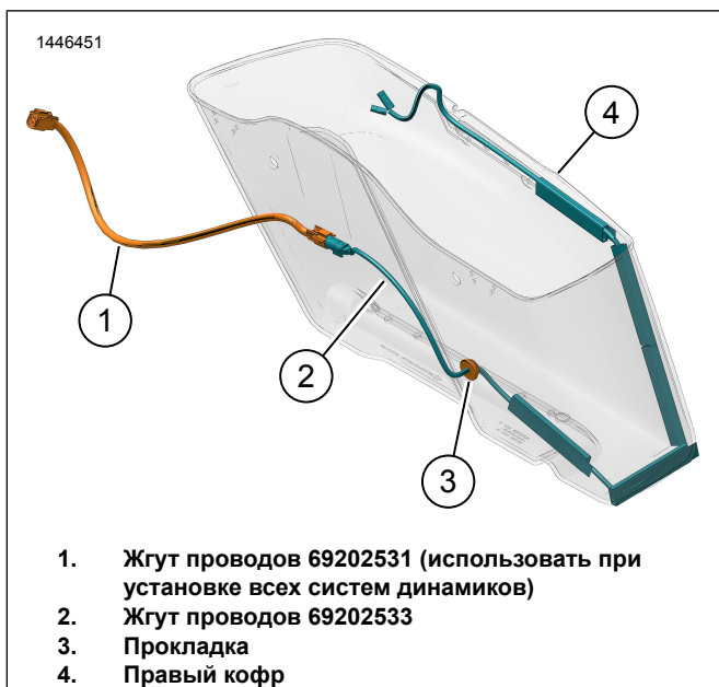
Рисунок 5. Укладка проводов в правом кофре (без усилителя)
