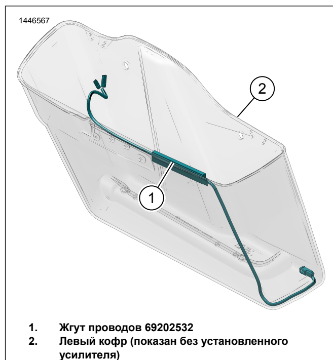
Рисунок 8. Укладка проводов в левом кофре
