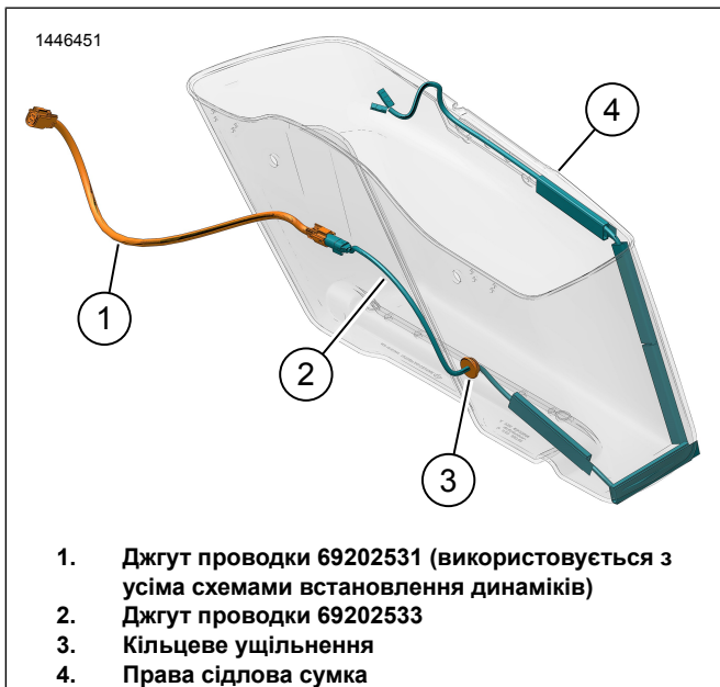
Малюнок 5. Прокладення джгута правої сідлової сумки (без підсилювача)
