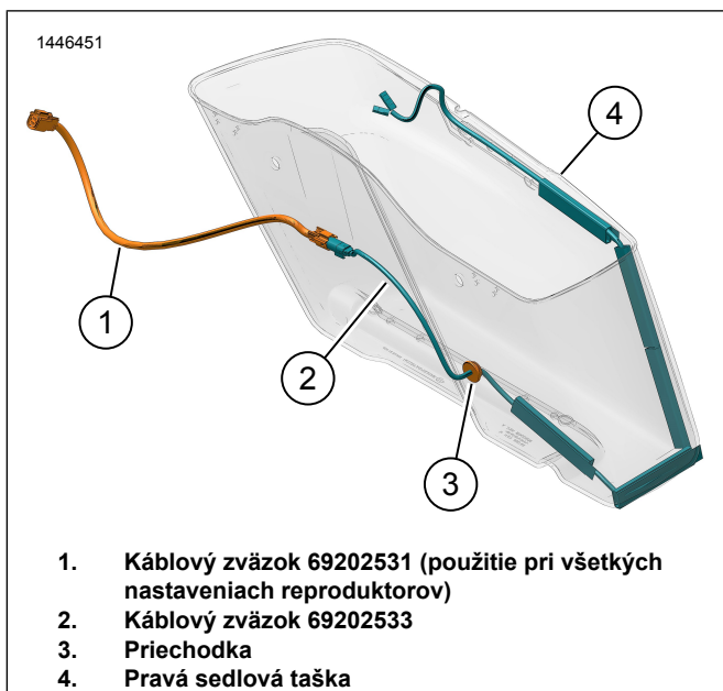
Obrazok 5. Trasa zväzku pravej sedlovej tašky (bez zosilňovača)
