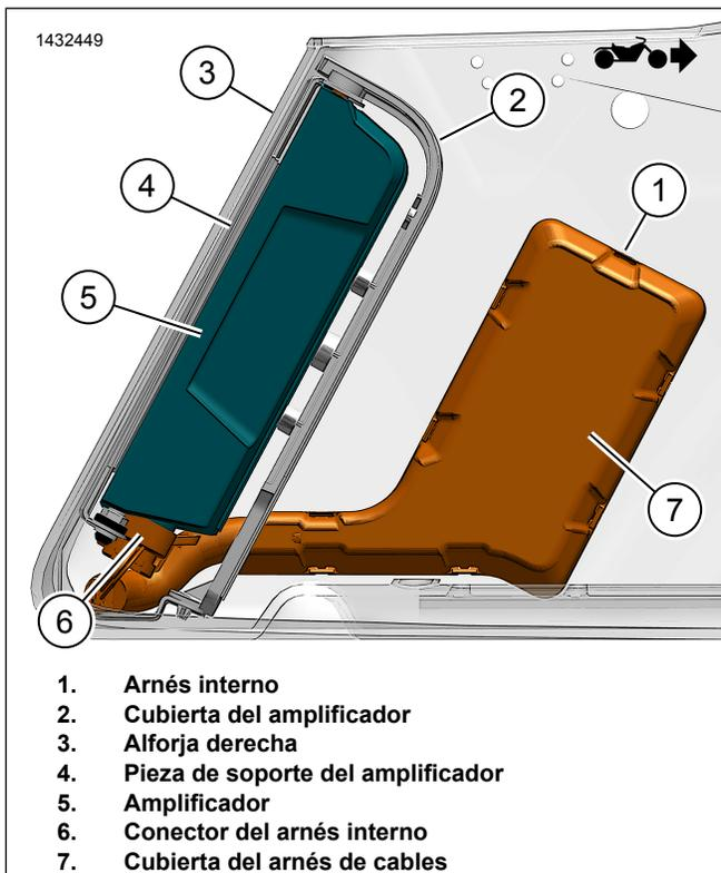
Figura 15. Arnés de la alforja con amplificador
