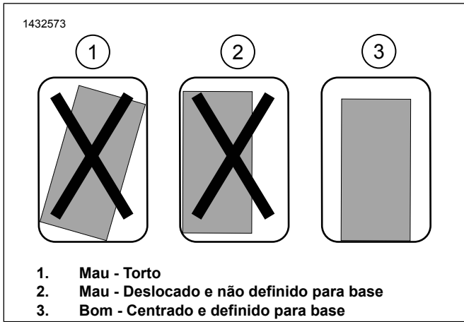
Figura 11. Instalação de suporte de montagem
