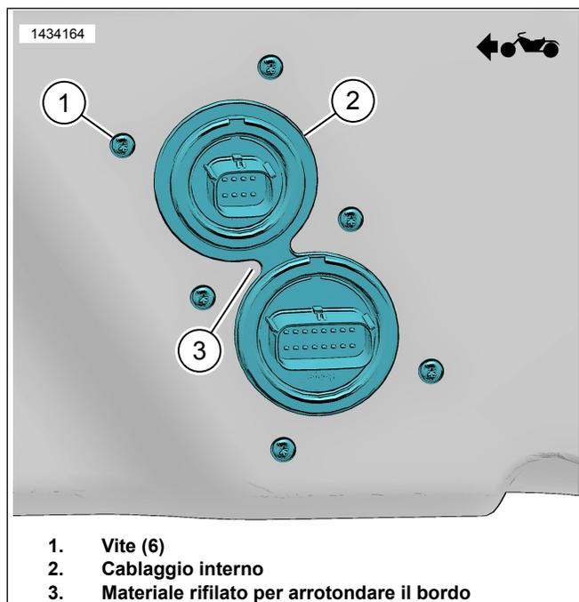
**Figura 10. Cablaggio interno**
