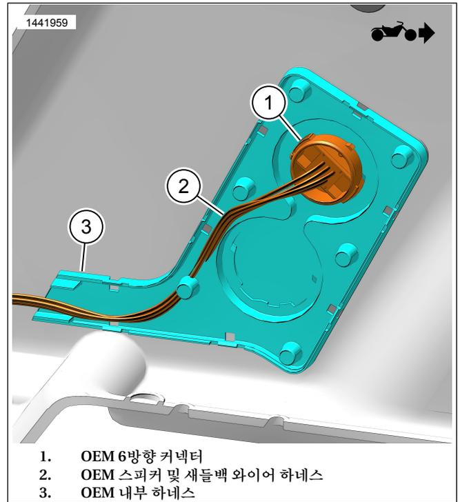
그림 6. OEM 내부 하네스(새들백 내부)
