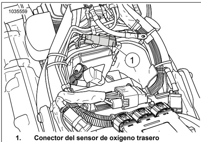
**Figura 31. Ubicación del sensor de oxígeno trasero**
