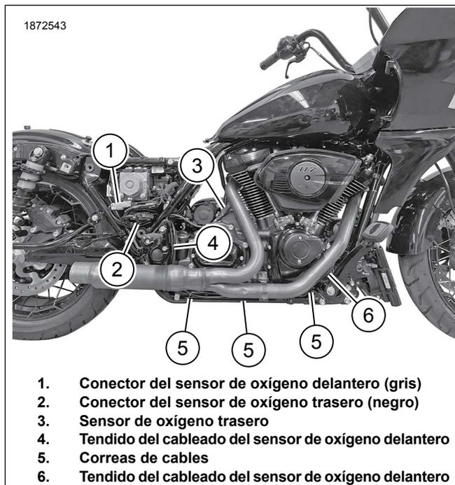
**Figura 8. Ubicación del arnés del sensor del ATM**
