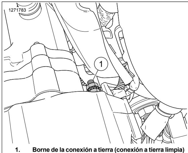
**1. Borne de la conexión a tierra (conexión a tierra limpia)**
