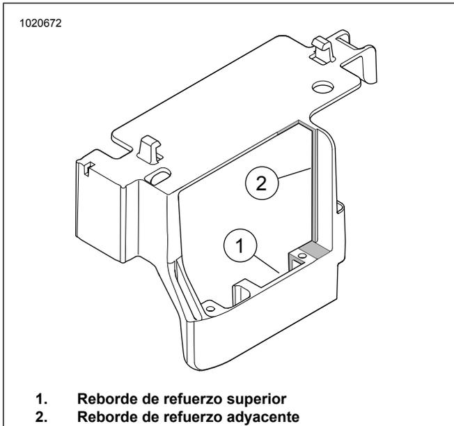
**Figura 30. Recorte de la parte trasera del portabaterías**
