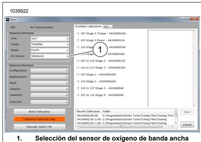
**Figura 26. Selección del sensor de oxígeno de banda ancha**
