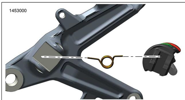
Figura 5. Orientación del resorte de retorno - Derecho
