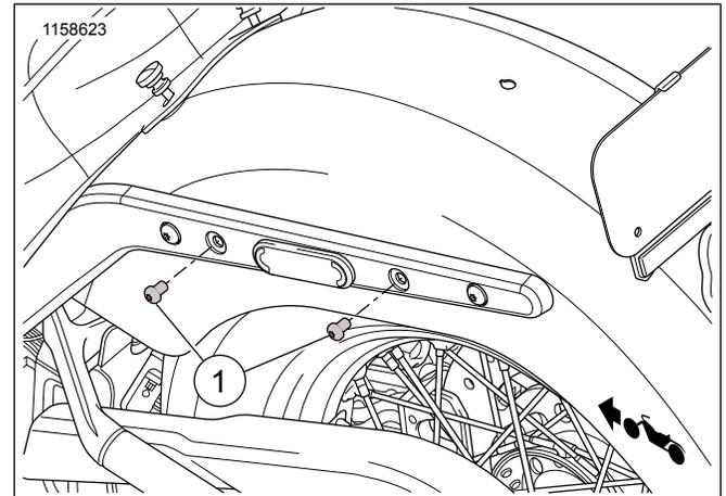
Figura 1. Retirada de tornillos - guardabarros trasero
