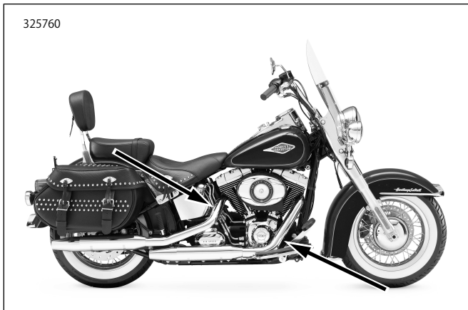
図33. オキシジェンセンサーの位置(エキゾーストパイプの内側)
