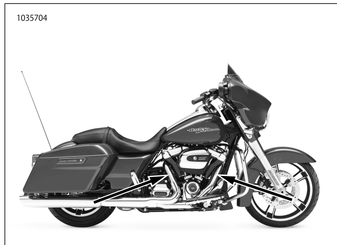
図11. オキシジェンセンサーの位置(エキゾーストパイプの内側)
