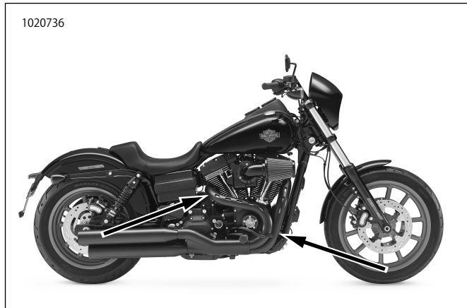
図40。オキシジェンセンサーの位置(エキゾーストパイプの内側)
