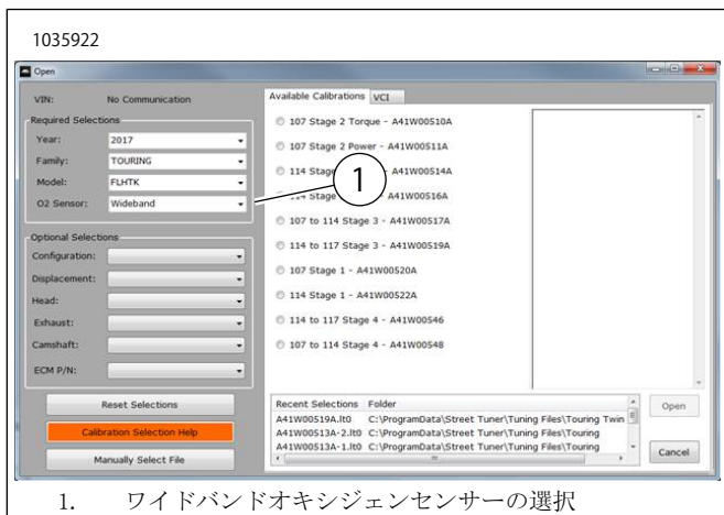
図26. ワイドバンドオキシジェンセンサーの選択
