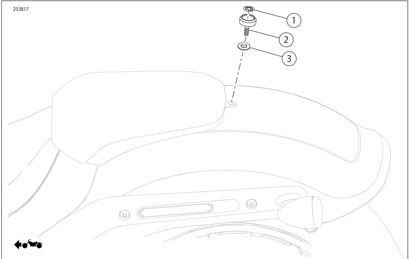
図1。キット内容: ライダーバックレストコンポーネント
