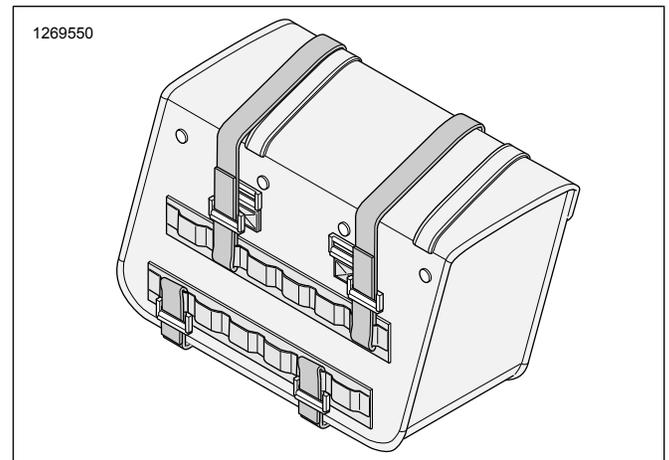
図2。マジックテープの取り付け(例)
