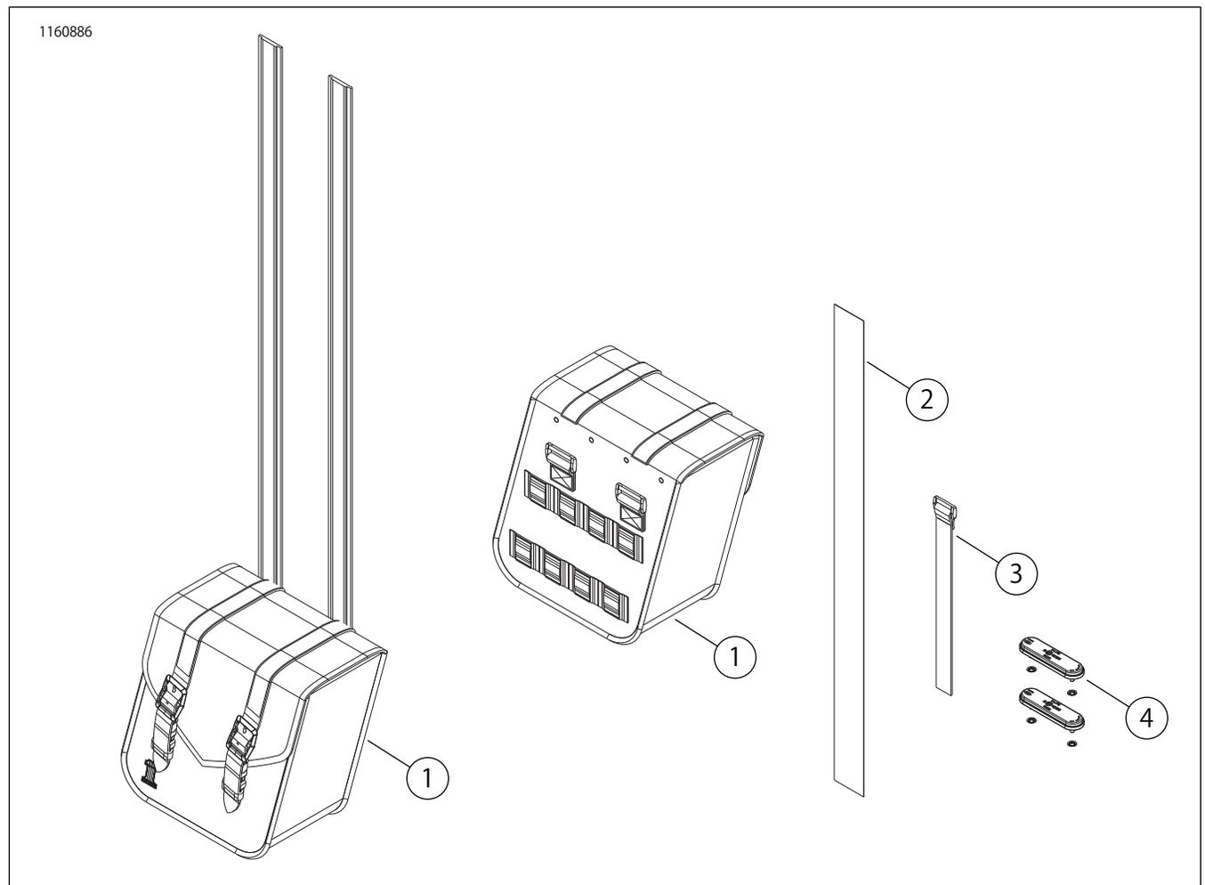
図4。交換用パーツ: スローオーバーサドルバッグキット (図はコンパクトタイプ)
