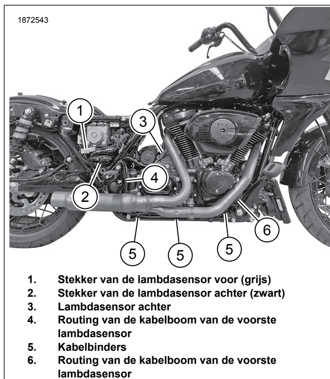
Afbeelding 8. Verloop van de kabelboom van de ATM-sensor
