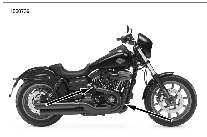
Afbeelding 40. Locaties van de lambdasensor (binnenzijde van uitlaatpijpen)
