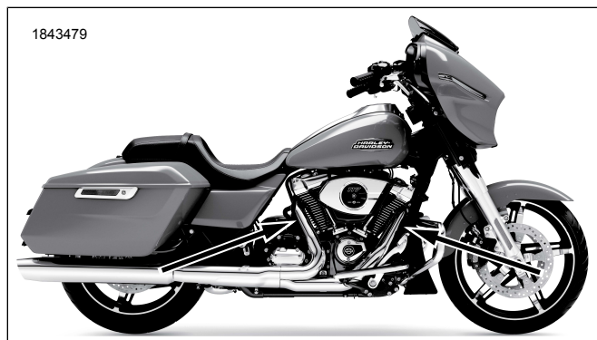
Afbeelding 2. Locaties van de lambdasensor (binnenzijde van uitlaatpijpen)
