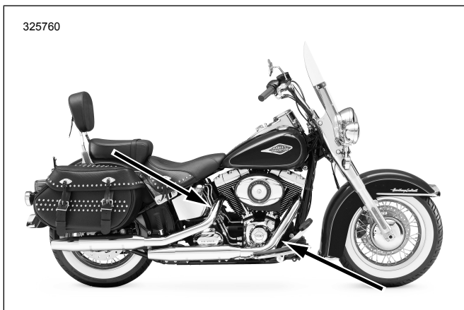
Afbeelding 33. Locaties van de lambdasensor (binnenzijde van uitlaatpijpen)
