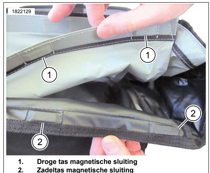
Afbeelding 12. Droge tas monteren
