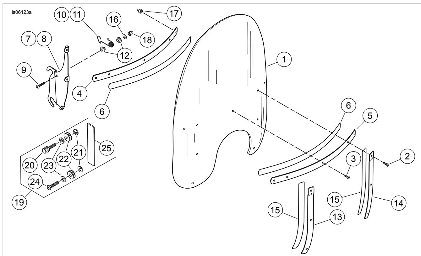
Figura 2. Parti di ricambio del kit parabrezza
