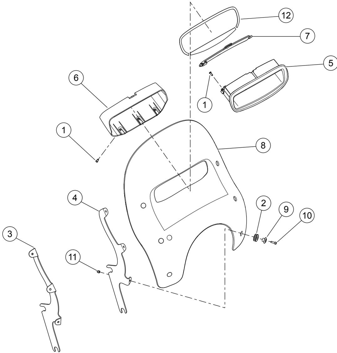
Figura 1. Parti di ricambio: Parabrezza smontabile con fessure di ventilazione
