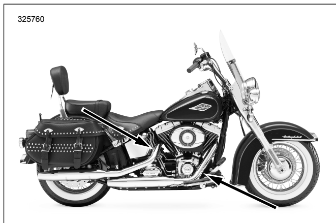
Figura 33. Posizioni dei sensori dell'ossigeno (lato interno dei tubi di scarico)
