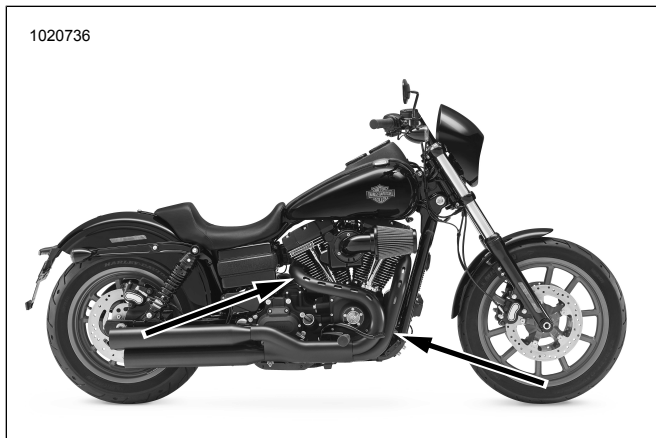
Figura 40. Posizioni dei sensori dell'ossigeno (lato interno dei tubi di scarico)
