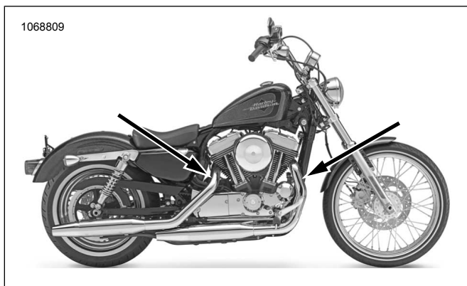
Figura 48. Posizioni dei sensori dell'ossigeno (lato interno dei tubi di scarico)
