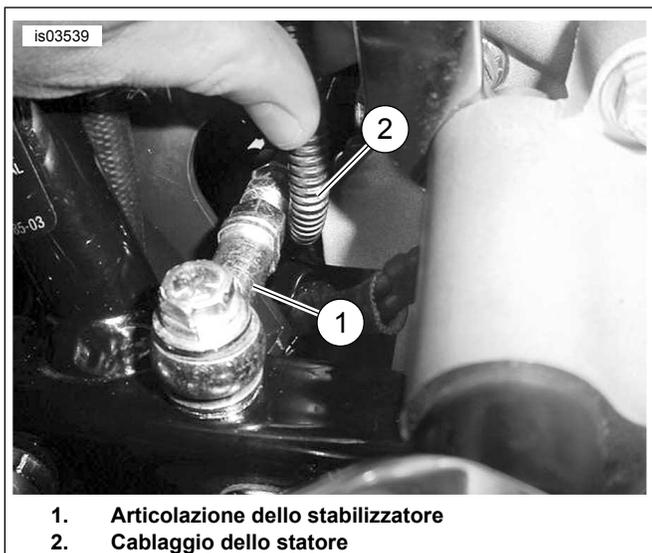
**Figura 4. Cablaggio dello statore e fermo a P**
