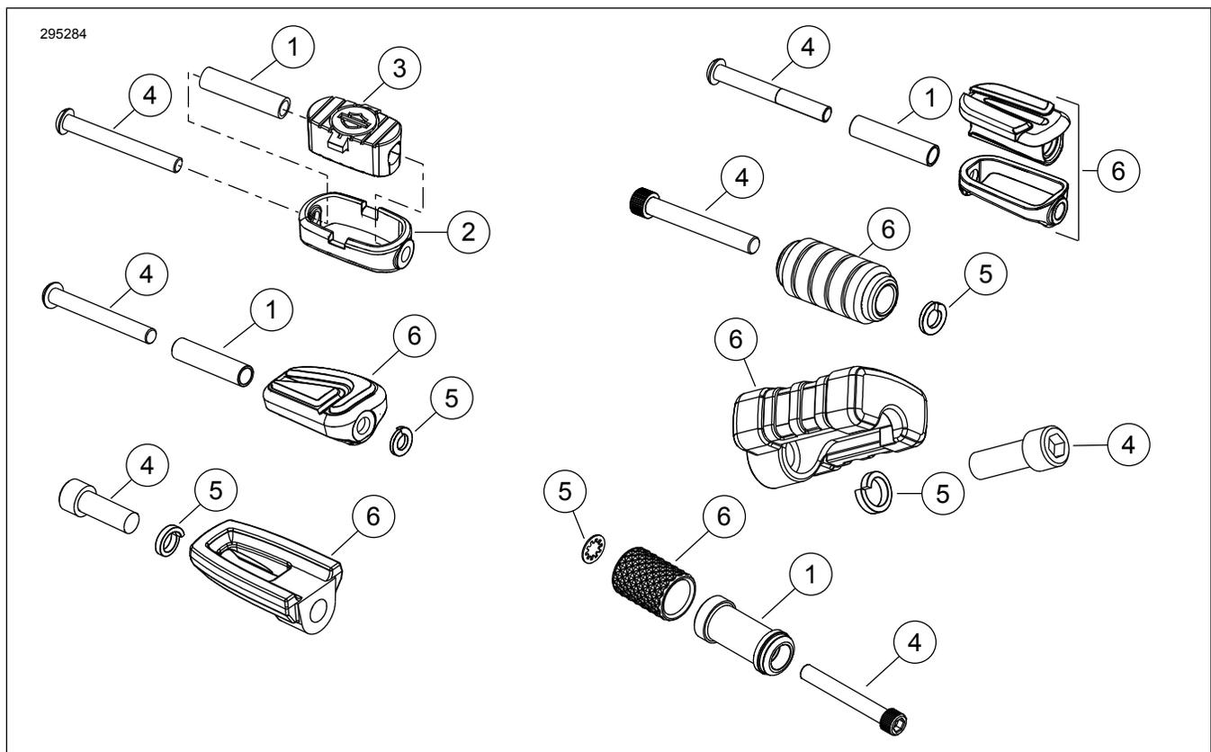
Figura 1. Contenuto del kit: Kit pedale del selettore delle marce
