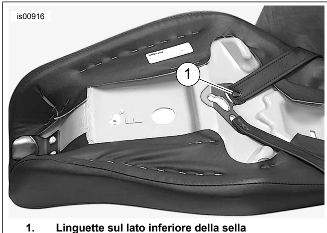
Figura 4. Lato inferiore della sella in cui è installata la cinghia di appiglio
